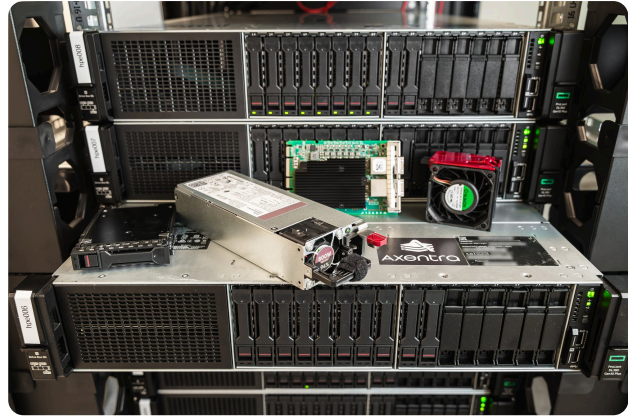
Reservedelspakken som fulgte med: SSD, strømforsyning, vifte og nettverkskort. Fortsatt urørt. Foto: Anders Bakken Photography
