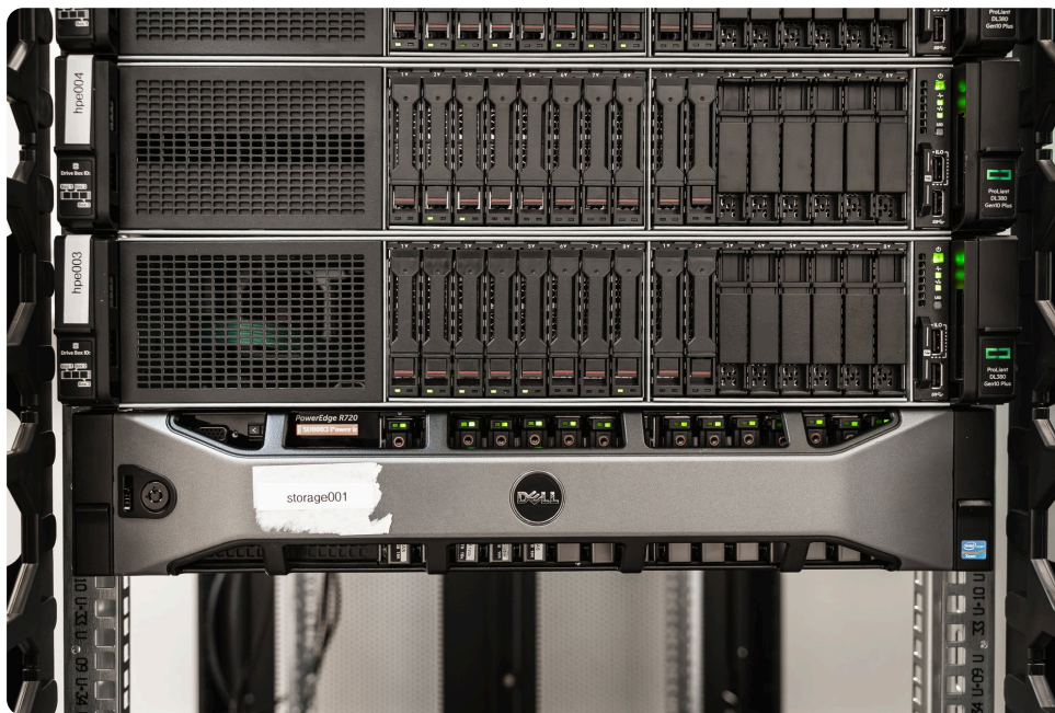
Nytt og gammelt i samme rack: DL380 Gen10 Plus over en av skolens Dell R720. Foto: Anders Bakken Photography
